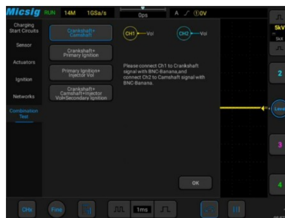
▲ Az elektronikus hibák bonyolultak lehetnek, az összegyűjtött különböző hullámformák összehasonlításával a felhasználó a hullámformák közötti időzítési és mennyiségi összefüggések elemzésével itéli meg a hibákat.
