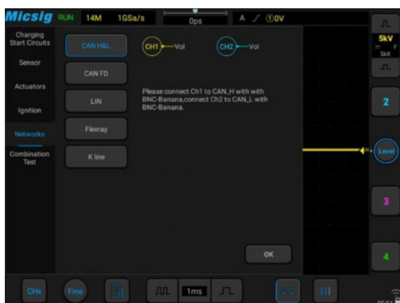
▲ A SATO1004 képes a CAN High/CAN Low, CAN FD, LIN, FlexRay és K vonal jelek fogadására és dekódolására, valamint professzionális hálózati kommunikációs tesztek végzésére a járműveken.
