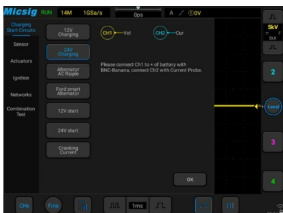
▲ S12/24V-os töltő- és indítási áramkör, AC hullámmosság, indítóáram tesztek
