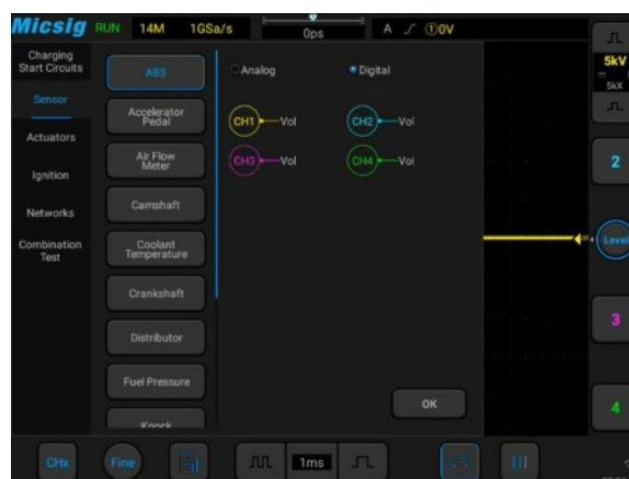
▲ A különböző érzékelők hullámformájának közvetlen mérése a szabványos hullámformával összehasonlítva segít a felhasználónak könnyen megtalálni a lehetséges problémát.
