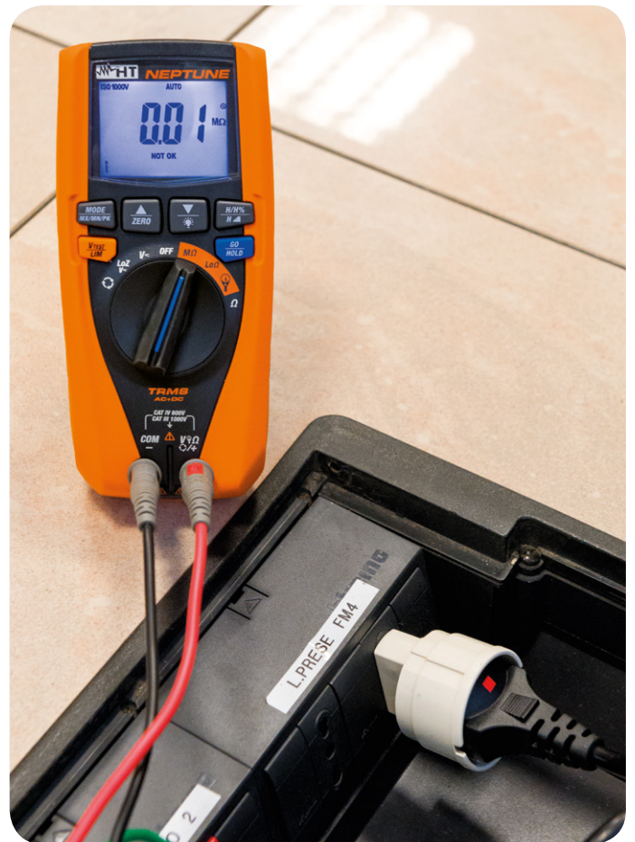
Szigetelési ellenállás mérése (opcionális Schuko C2065 adapterrel).
