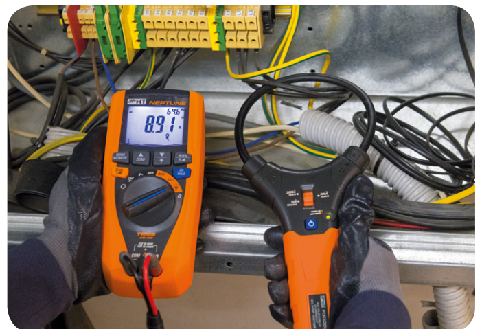
Árammérés az F3000U flexibilis lakatfogóval
