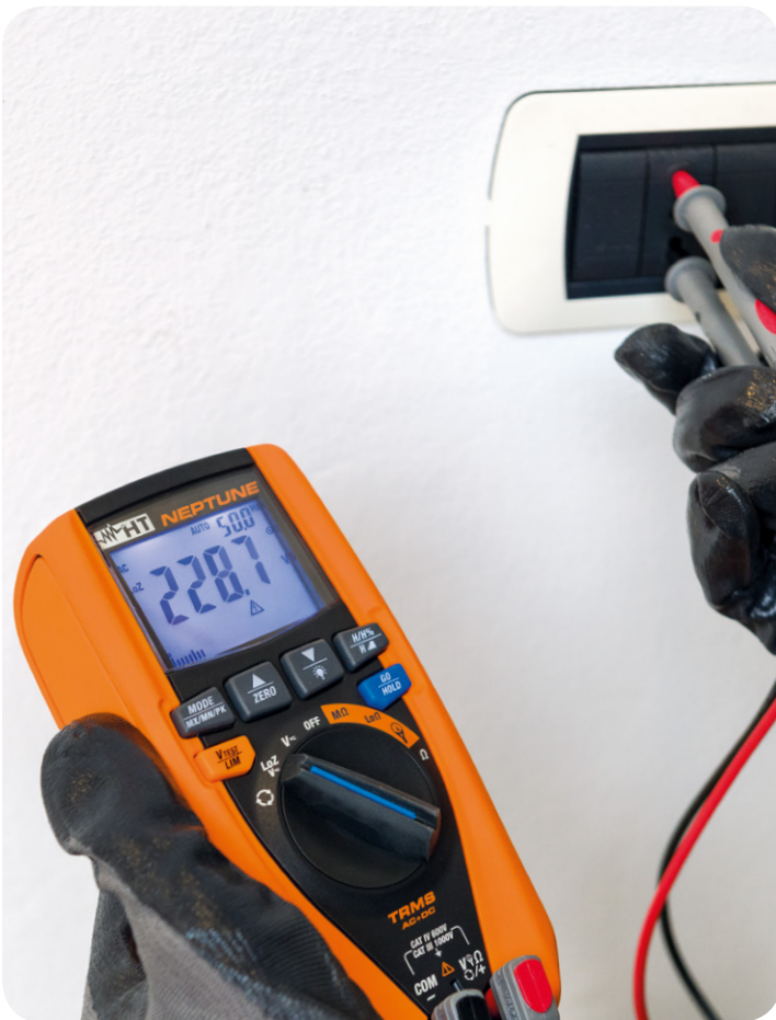
A szórt kapacitások okozta hatások nullázása.
