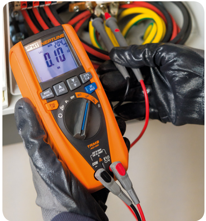
Védővezetők folytonosságának vizsgálata 200 mA-rel
