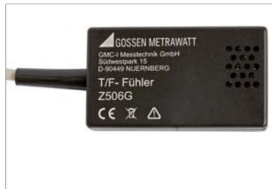
Adapter hőmérséklet és páratartalom mérésére mágneses rögzítővel. Mérési adatátvitel és tápellátás (5 V DC  $\pm 10\%$ ) a vizsgálóműszer 9 tűs RS 232 portjához való csatlakozáson keresztül.
