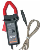
C-5A lakatfogó ( \Phi 39 mm) 1000 A AC/DC
