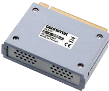
DS2-FGN DDS-típusú funkció generátor 5 MHz sávszélességgel
