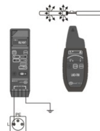
Vezetékkeresés és szakadás behatárolása
