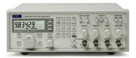
0.001Hz... 10MHz frekvencia tartomány DDS technika 6-digites, vagy 1mHz beállítási felbontás 1ppm stabilitás és <10 ppm abszolút éves pontosság Szinusz, négyszög és háromszög hullámformák Kis torzítású, nagy spektrális tisztaságú szinusz A frekvencia és amplitúdó/eltolás egyidejű kijelzése Külső 7-szegmenses kijelzővel rendelkező 120 MHz-es frekvenciamérő
