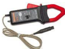
C-5A lakatfogó (Ø=39 mm) Index: WACEGC5OKR
