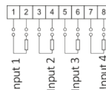
4 PT100 bemenet 2-vezeté- kes bekötésben, vagy ellenállásmérés 400 Ω-ig
